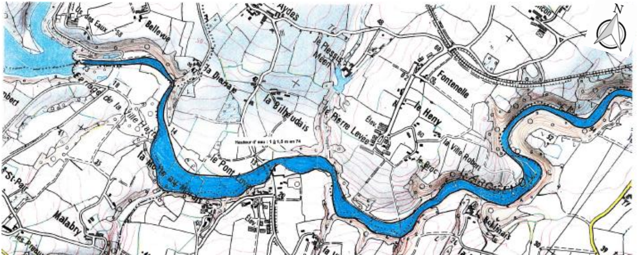
Figure 19 : Enveloppe de la zone inondée pour une crue de type 1974 entre le barrage de la Ville Hatte et Plancoët
