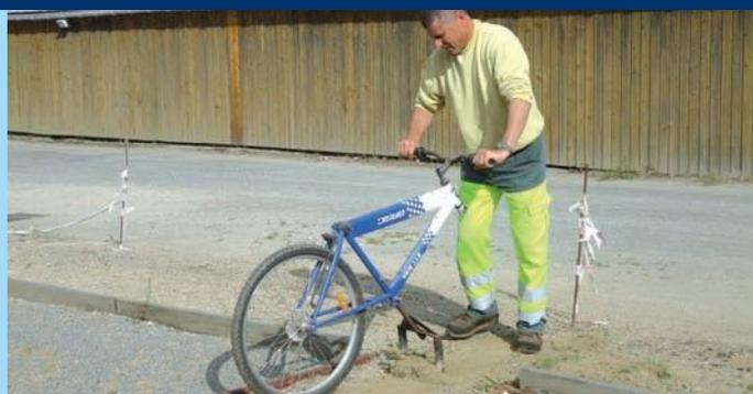
Utiliser des outils pour faciliter l'arrachage des herbes dans les graviers. La photo montre un outil à lame conçu par un agent communal à partir d'un vélo.
