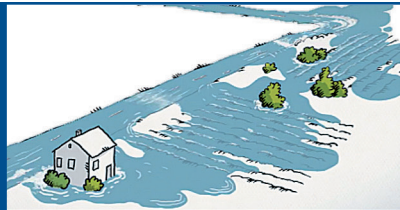
Rivière calibrée* : accélération du flux et aggravation des inondations
