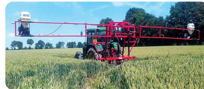
Développement de Maxi couv sur le territoire. Cet outil permet d'effectuer des semis de couverts végétaux sur une culture avant moisson. Cela permet de limiter le temps pendant lequel le sol se retrouve à nu après la récolte.
