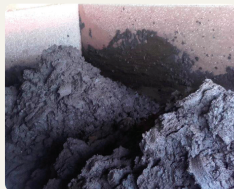
Terre extraite de l'eau à traiter, pompée dans la retenue de l'Arguenon
